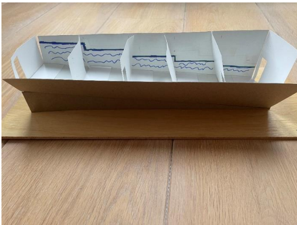
Schema van een De Wit vispassage (boven) en de maquette die ik gemaakt van zo'n passage (onder).
