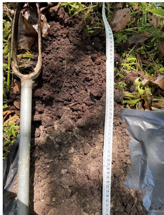
Grondboring op de oever van de Woldsloot juli 2023. Na bijna een meter was er veenachtige grond (bovenin op de foto's)
