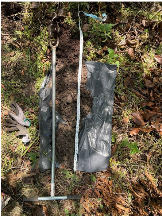
Grondboring op de oever van de Woldsloot juli 2023. Na bijna een meter was er veenachtige grond (bovenin op de foto's)
